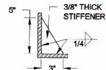
2 TYP. STIFFENER SCALE: 1 1/2" = 1'-0"
